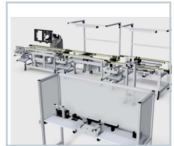
Backend-Montagelinie für Photovoltaik-Module mit Rahmenfügevorrichtung
